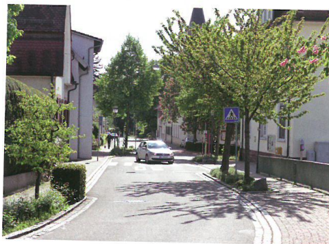
Bild 17: Zu kleine Baumgruben sowie kleinteilige und lückenhafte Bepflanzungen erhöhen die Pflegekosten und verkürzen die Lebensdauer. (Quelle: Monika Böhm)
